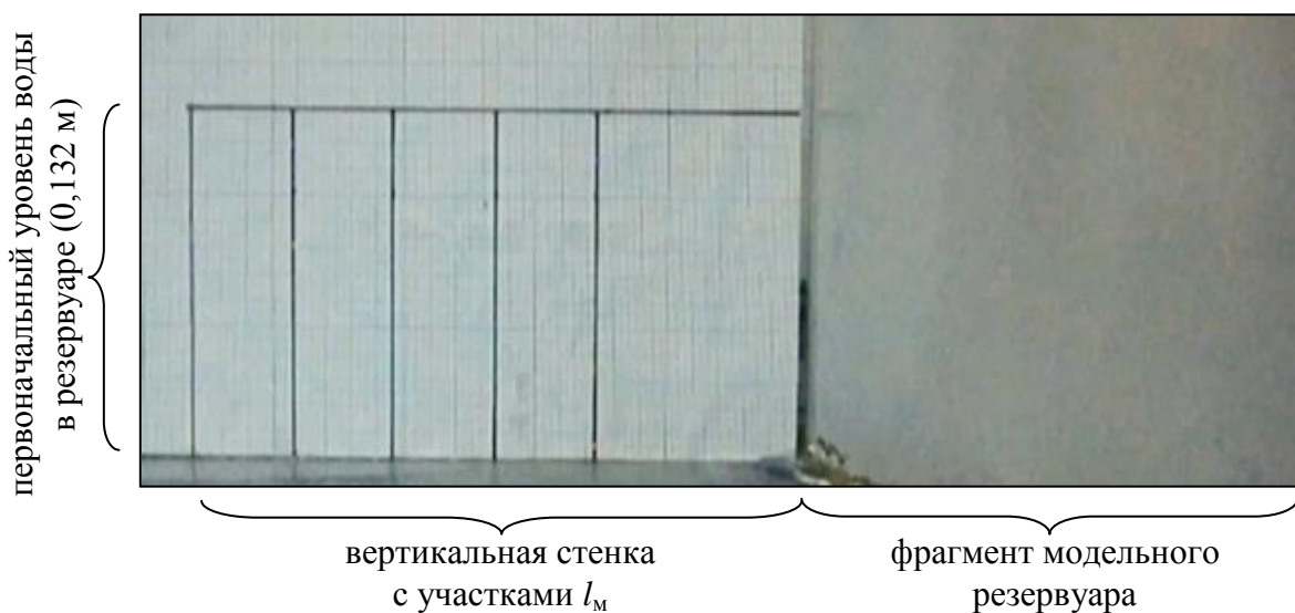
Рисунок 2.21 – Общий вид участка лабораторного стенда перед проведением опытов по оценке высоты потока в соответствующие моменты времени на расстояниях l_m
