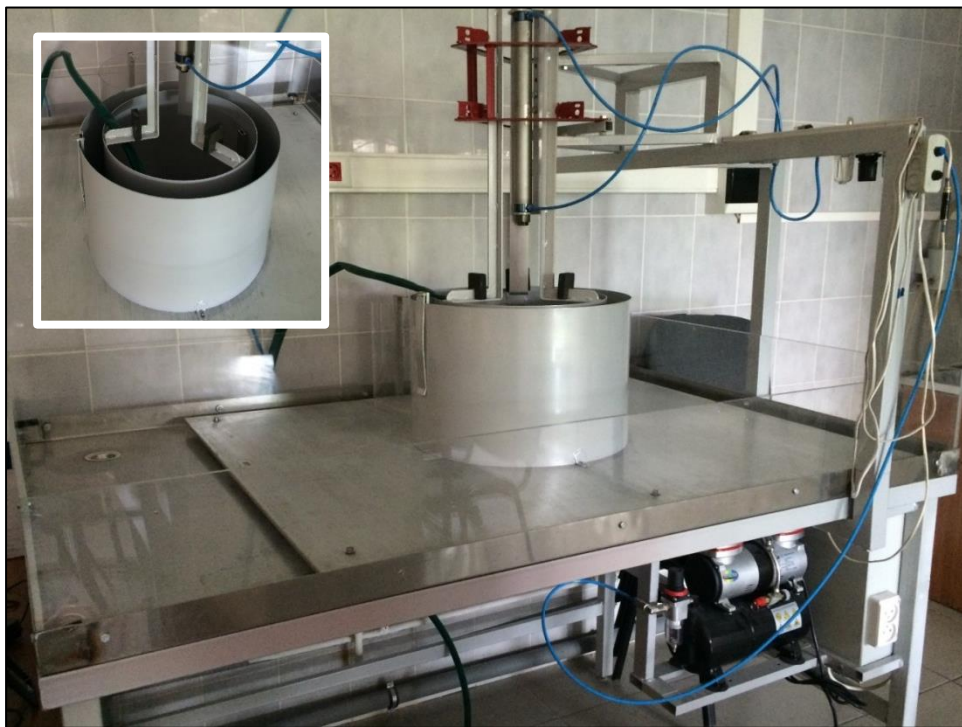
Рисунок 2.19 – Общий вид лабораторного стенда с модельным резервуаром и защитной стенкой
