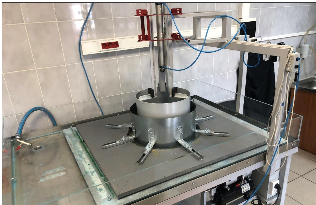
Рисунок 3.2 – Общий вид лабораторного стенда со специальной вставкой и закрепленной на ней защитной стенкой
