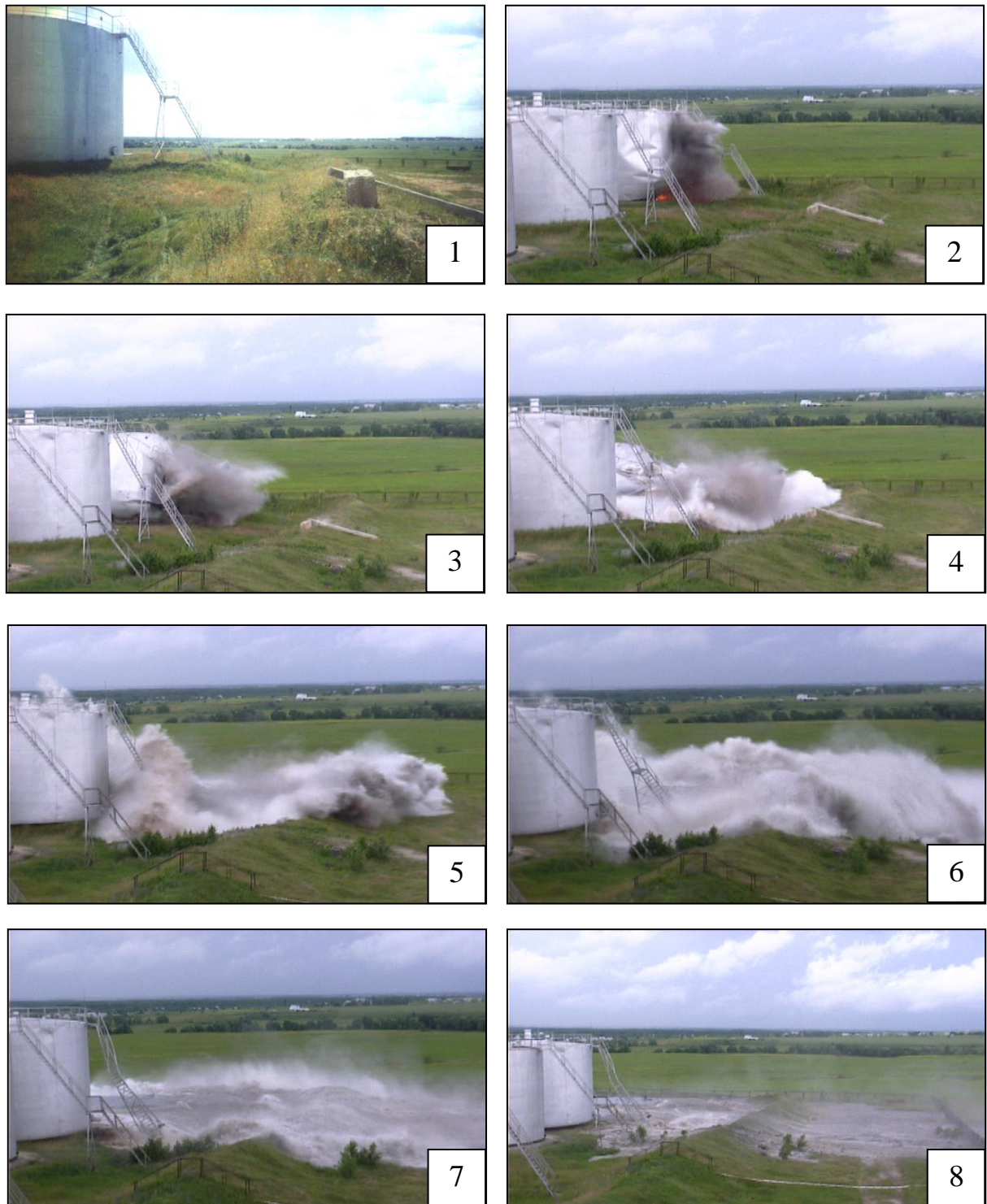
Рисунок 2.14 – Кадры видеосъемки полного разрушения РВС-700 м 3 с водой
