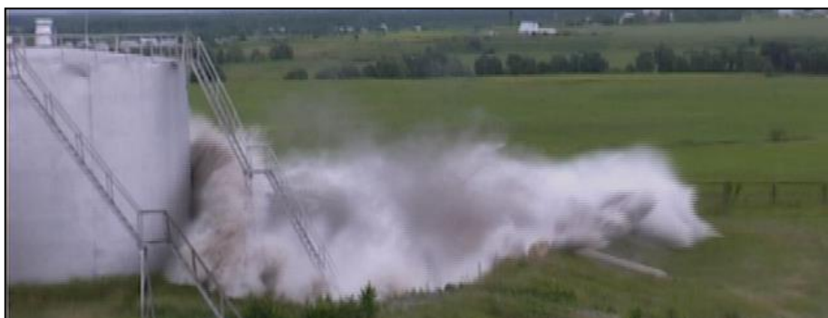
Рисунок 2.16 – Характерные кадры видеосъемки полного разрушения РВС-700 м 3 с водой в соответствующие моменты времени
