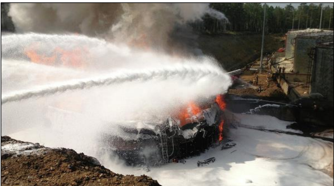
Рисунок 1.17 – Фрагмент тушения пожара разлива нефти в резервуарном парке
